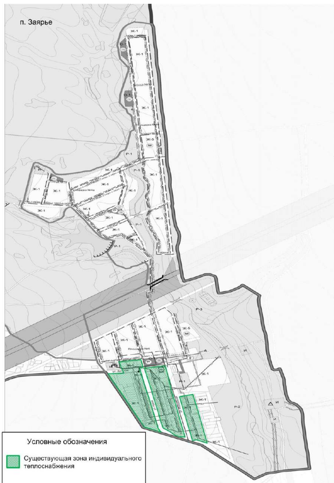
Рисунок 1.4.4 – Зоны действия индивидуальных источников тепловой энергии п. Заярье
