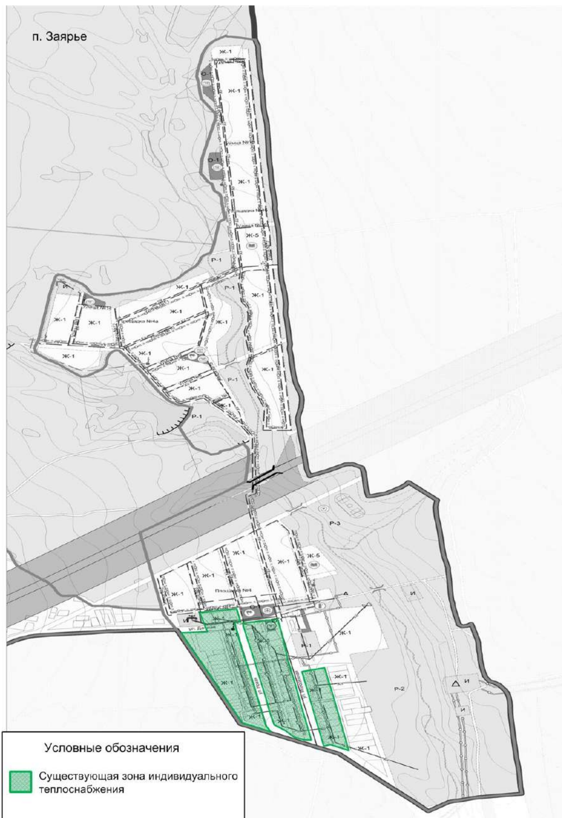
Рисунок 1.1.1.4 – Зоны действия индивидуальных источников тепловой энергии п. Заярье
